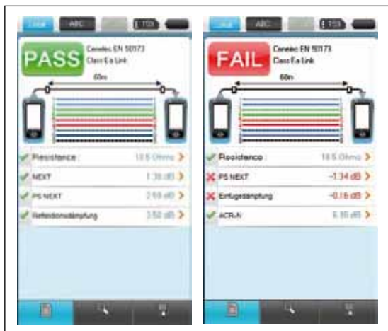
Bild 4. Beispiele der Autotest-PASS- und -FAIL-Anzeige eines Kabelzertifizierers.
